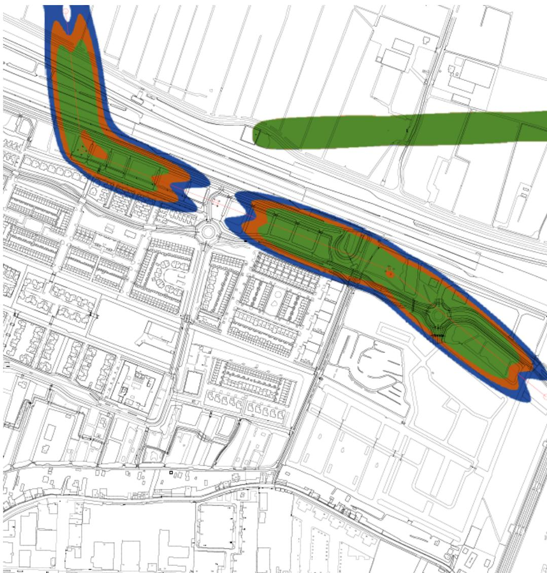
Figuur 4: Magneetveldzone op basis van prognose uit 2018 (geoptimaliseerd)
