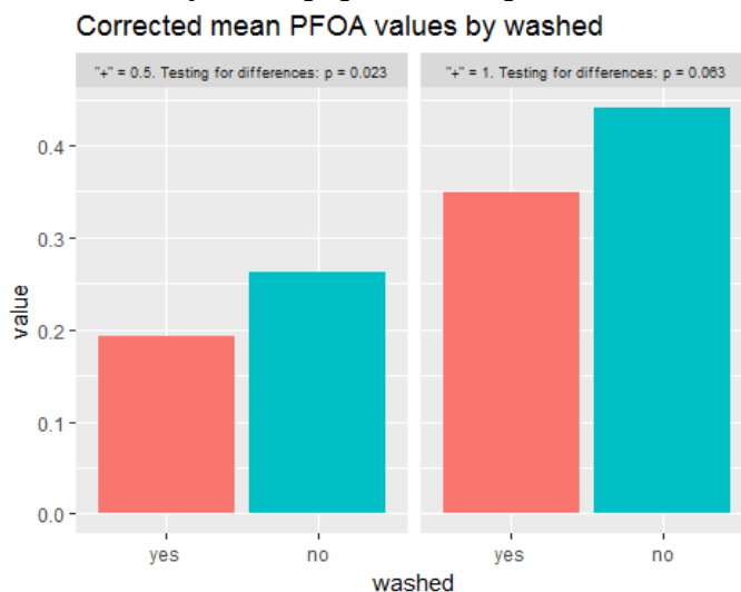
Figuur 4.4. Invloed van wassen op de gemeten PFOA concentraties, waarbij de "+" resultaten gelijk zijn gesteld aan 0,5 of 1 ng/g
